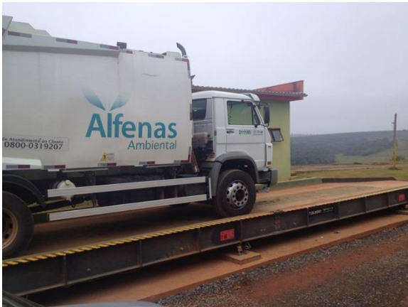
Figura 297 – Balança rodoviária para pesagem dos caminhões
