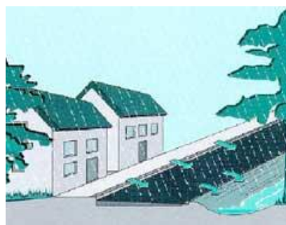
Figura 321 - Sistema de drenagem em valas de infiltração
