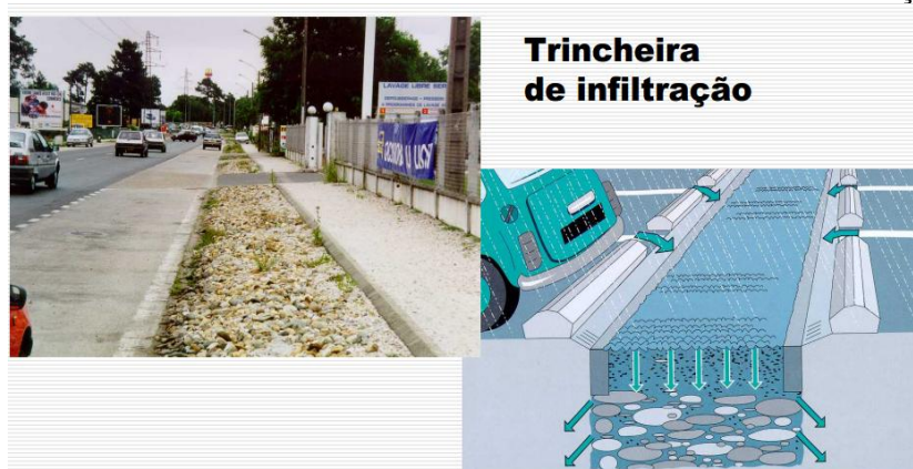
Figura 41 - Controle no sistema viário: trincheira de infiltração
