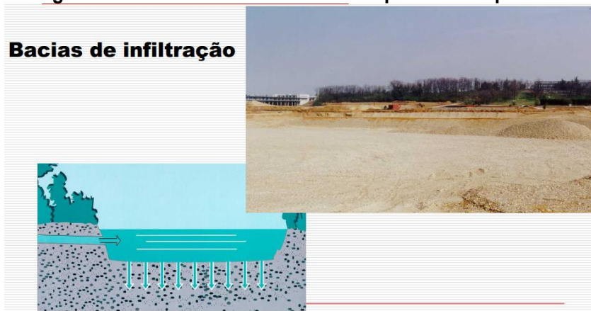
Figura 45 - Controle a jusante: Bacias de infiltração
